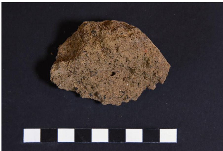
Obrázek 3: Vzorek M1, makrosnímek fragmentu vzorku omítky, dílek měřítka odpovídá 1 cm
