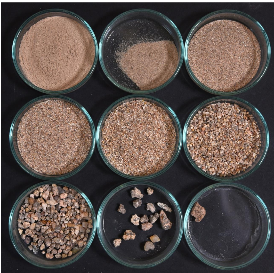
Obrázek 4: Vzorek M1, frakce kameniva, zleva nahoře <0,063; 0,063-0,125; 0,125-0,25; 0,25-0,5; 0,5-1; 1-2; 2-4; 4-8 a > 8 mm, průměr petriho misky 5 cm
